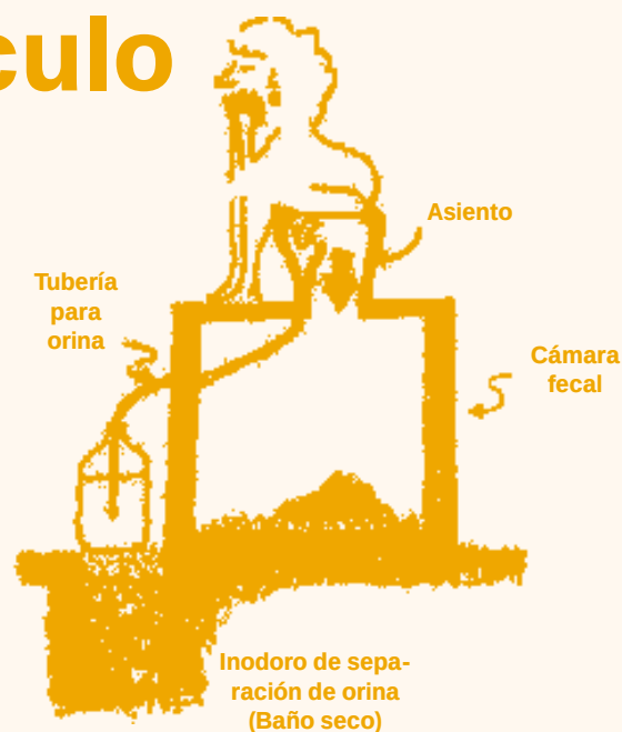
Figura 2: Los inodoros de separación de orina facilitan el tratamiento y la reutilización.
