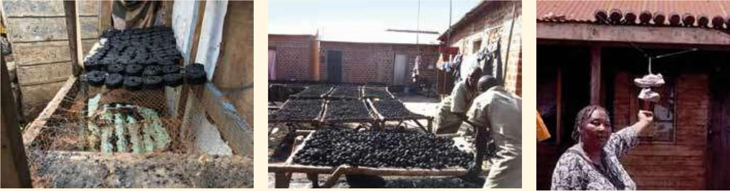
(a e b) Secando briquetes sobre telas de arame em Kampala; e (c) sobre o telhado em Nairóbi
