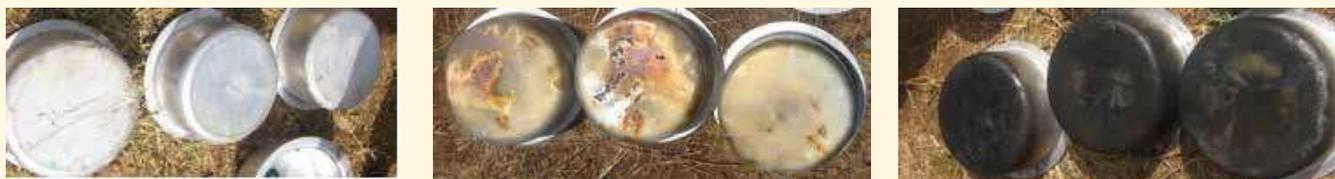
Aspecto das panelas após 3 horas de cozimento com (a) briquetes, (b) carvão e (c) querosene.
