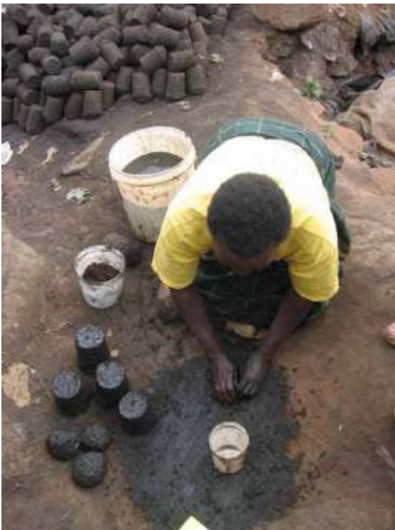
Moldando briquetes com ajuda de um recipiente plástico Foto: Mary Njenga
